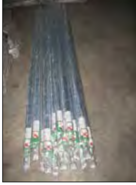
Şekil 4: Galvanize TAM dolgulu boru
