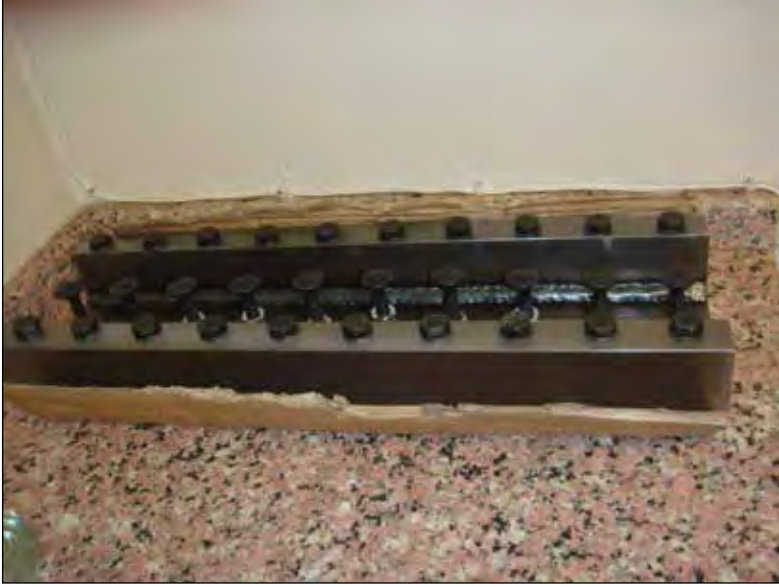
Şekil 4. İmalatı tamamlanan v restraint test düzeneğinin fotoğrafı
