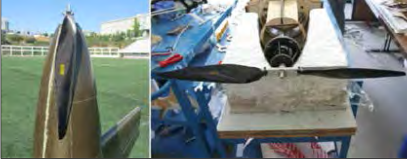
Şekil 8. Katlanabilir pervanenin çalışma prensibi; pervane dönmezken gövde üzerine katlanır (üst fotoğraf) ve sürüklemeyi azaltır; dönüşe başladığı zaman açılır ve görevini yerine getirir (alt fotoğraf)
