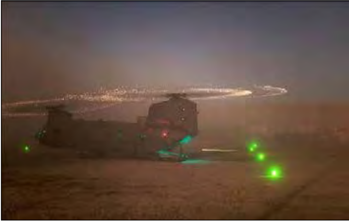
Şekil 14 : Arklar ve kıvılcımlar oluşan helikopter görüntüsü
