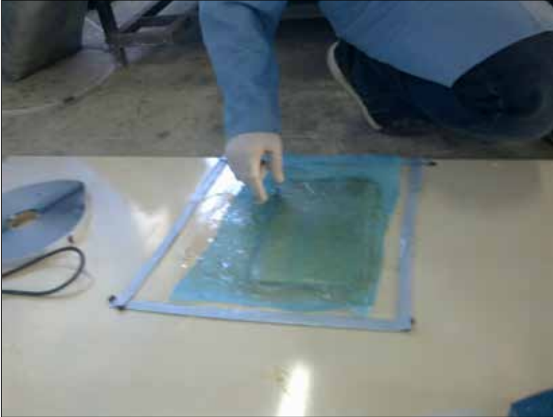
Şekil 4. ıslatılan elyafların üstüne delikli vakum torbası koyulur
