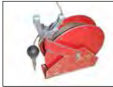
Şekil 5: Kelepçe ve fişli kablo makarası topraklama
